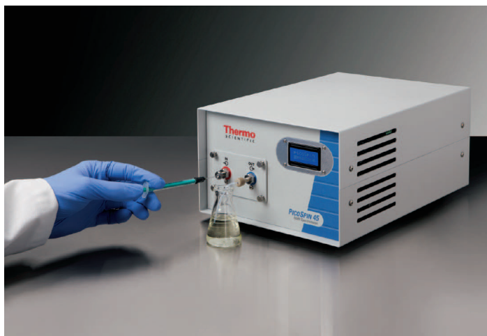
图 2 将样品注入 picoSpin™ 进样毛细管中
